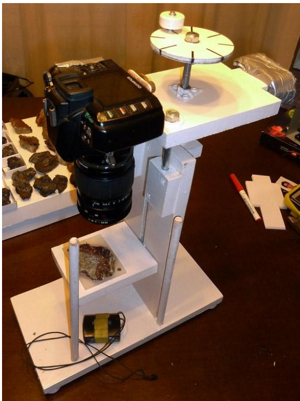
Foto nº 6. Soporte para cámara con desplazamientos controlados terminado
